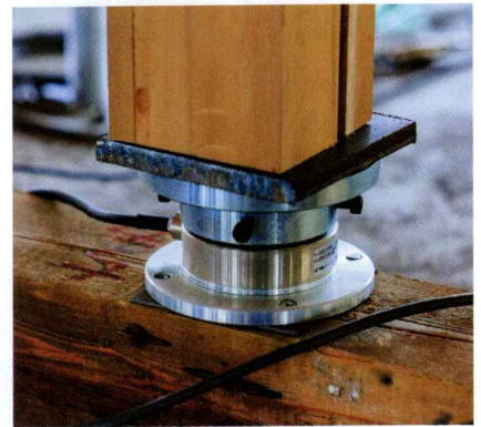
柱の基礎部分には、荷重計が 取り付けられている
