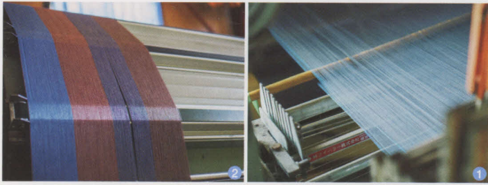
1 極細の糸は織り機でも切れやすい。伝統の低速織機でゆっくり、糸に負担をかけずに織り上げる。2 織り機にかける糸の束を用意する工程「整経」。超極細糸を使った「武藤」のストールの生地は、繊細な作業の積み重ねで、手くばり目くばりが欠かせない。
