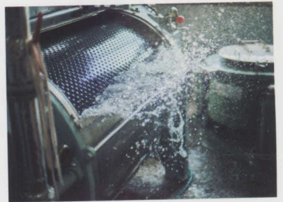
ドラムに布を入れて洗う、ウォッシュ加工。工場では2つの井戸から地下水をくみ上げ、きれいな水を潤沢に使っている。
